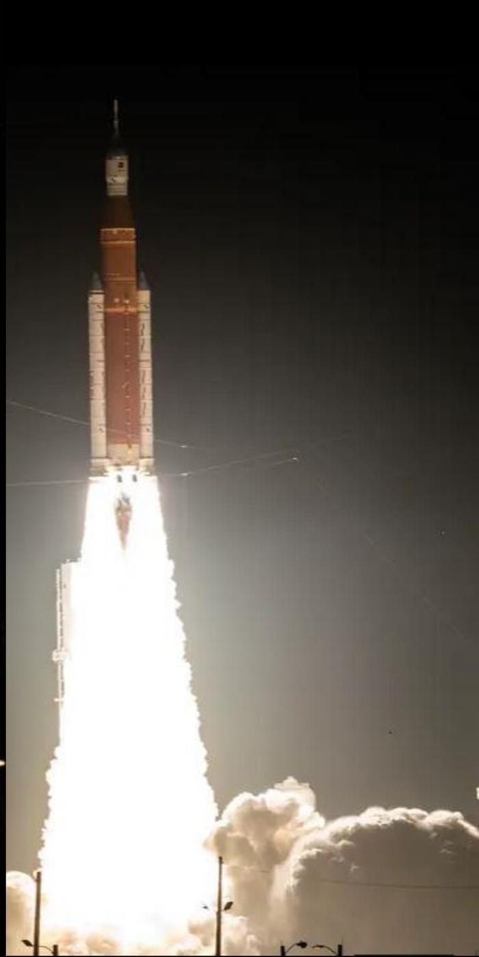
**Lancio di Artemis I di fatto il primo test integrato del sistema SLS e Orion. Alla partenza SLS è del 13% più potente del Saturn V.**
